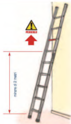
Scala semplice in appoggio a gradini o a pioli ed un solo tronco
